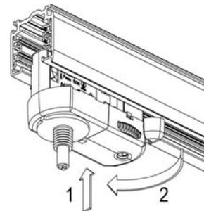
Zum Ausbau des Adapters Spannriegel (2) umlegen und Adapter (1) herausnehmen.
