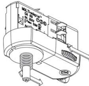
Zum Aufspannen des Adapters diesen gegen Stromschiene drücken (1) und Spannriegel (2) umlegen.
